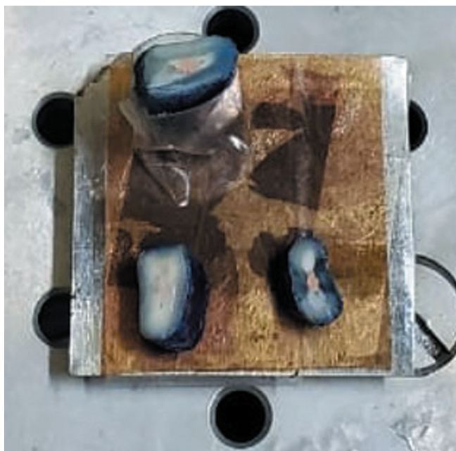
Рис. 1. а - наклеенный образцы на медную пластину с помощью двухстороннего электропроводного скотча без напыления. б – наклеенный образцы на медную пластину с помощью двухстороннего электропроводного скотча после напыления платиной в атмосфере аргона.
