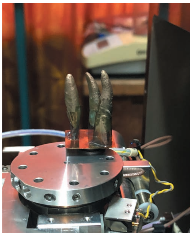
Рис. 2. Электронная микроскопия. Подготовительный этап. Помещение образцов в SEM LEO-1430 VP. Carl Zeiss. Германия
