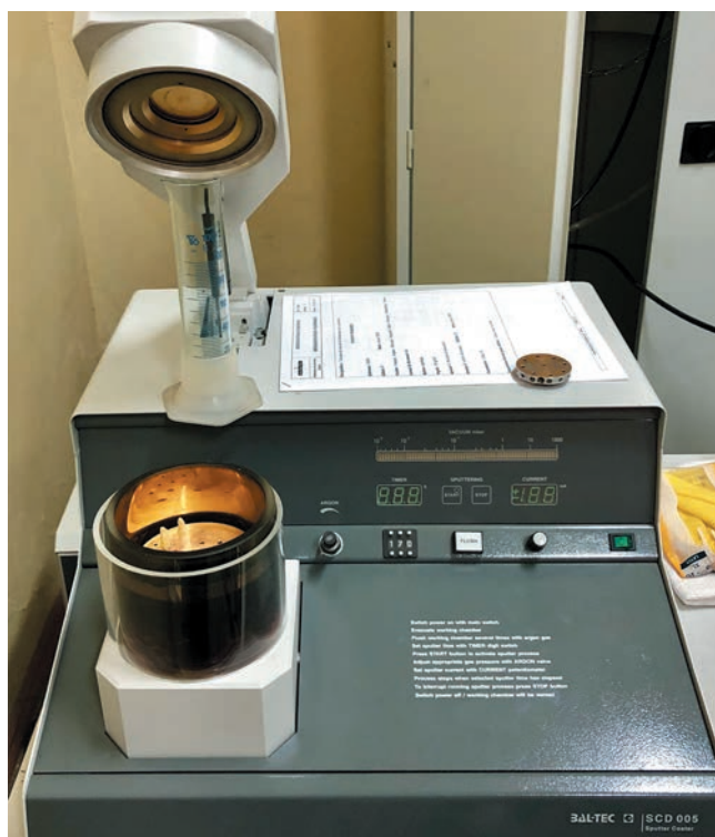
Рис. 1. Электронная микроскопия. Подготовительный этап. Напыление образцов золотом методом катодного напыления в среде аргона
