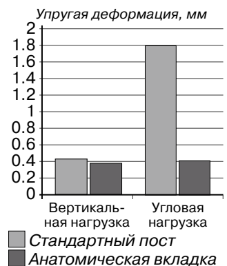
Рис. 7. Упругая деформация в стандартных и анатомических стекловолоконных постах при действии угловой нагрузки
