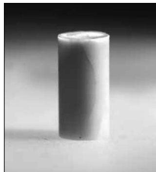
Рис. 2. Вертикальная трещина, образовавшаяся в стенке образца
