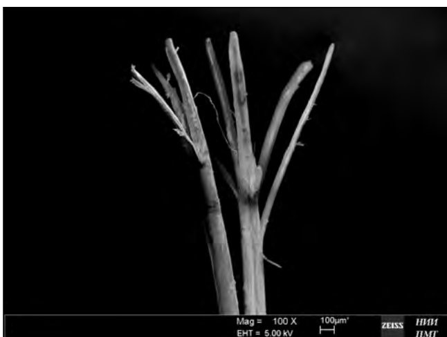
Рис. 1. Щетинка силового выступа мануальной зубной щетки через 1 месяц использования. Справа — щетинка силового выступа мануальной зубной щетки через 2 месяца использования. РЭМ
