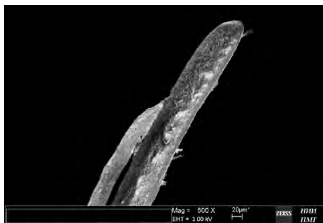
Рис. 2. Щетинка мануальной зубной щетки после трехмесячного использования. Изменение структуры стенки щетинки. Справа – щетинка электрической зубной щетки через 1 месяц использования. Изменения микрорельефа стенки щетинки. РЭМ
