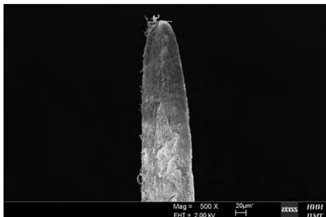
Рис. 4. Щетинка звуковой зубной щетки через 1 месяц эксплуатации. Справа – щетинка звуковой зубной щетки через 2 месяца эксплуатации. РЭМ
