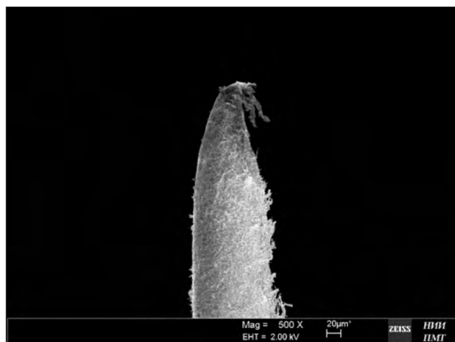
Рис. 3. Щетинка электрической зубной щетки через 2 месяца эксплуатации. Справа – щетинка электрической зубной щетки через 3 месяца эксплуатации. РЭМ
