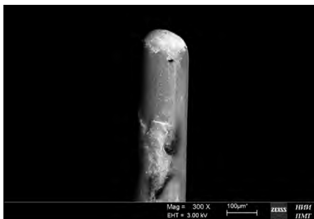
Рис. 2. Щетинка мануальной зубной щетки после трехмесячного использования. Изменение структуры стенки щетинки. Справа – щетинка электрической зубной щетки через 1 месяц использования. Изменения микрорельефа стенки щетинки. РЭМ
