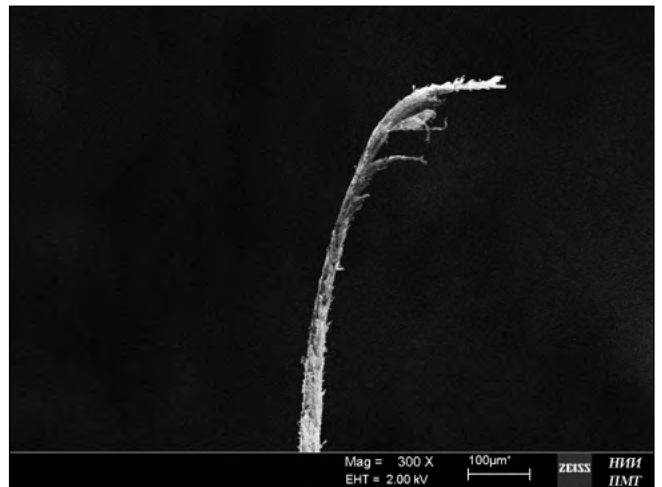
Рис. 6. Щетинка ионной зубной щетки через 2 месяца использования. Справа – щетинка ионной зубной щетки через 3 месяца использования. РЭМ
