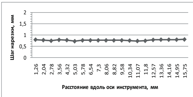
Рис. 13 Шаг нарезки инструмента ProFile 30.04 остается неизменным по длине всей режущей части от верхушки к хвостовику
