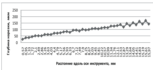
Рис. 10. Глубина нарезки инструмента ProFile 25 .04 относительно равномерно нарастает по всей длине режущей части от верхушки к хвостовику
