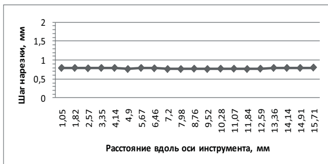
Рис. 8. Шаг нарезки инструмента ProFile 25 .04 остается неизменным по всей длине режущей части от верхушки к хвостовику
