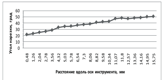
Рис. 14 Угол нарезки инструмента ProFile 30.04 в целом довольно равномерно увеличивается в направлении от верхушки к хвостовику
