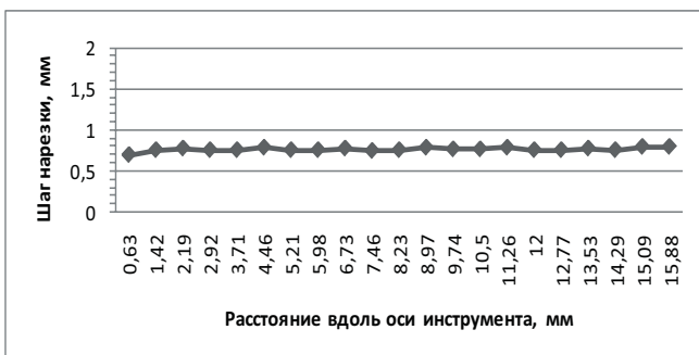
Рис. 3. Шаг нарезки инструмента ProFile 20.04 остается неизменным по всей длине режущей части от верхушки к хвостовику
