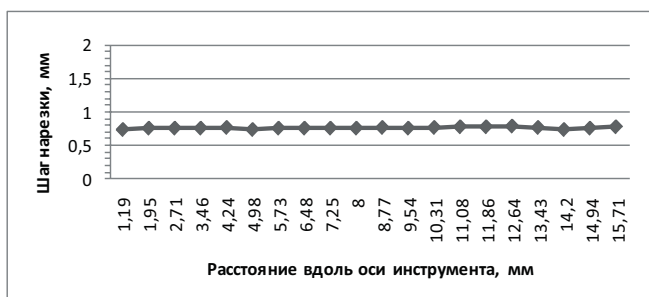
Рис. 28. Значение шага нарезки инструмента ProFile 30.06 остается неизменным по длине всей режущей части от верхушки к хвостовику
