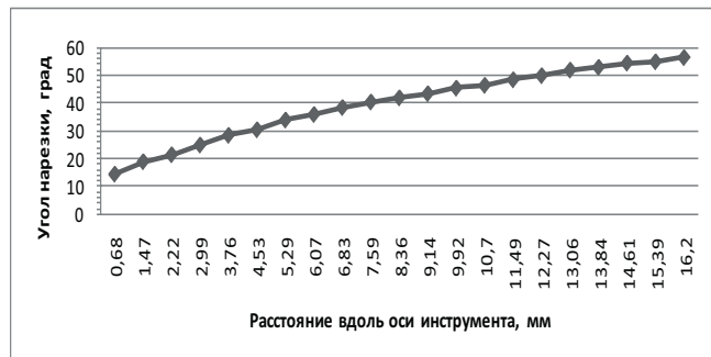
Рис. 19. Значения угла нарезки инструмента ProFile 20 .06 довольно резко увеличиваются примерно до середины режущей части инструмента, последующее увеличение угла нарезки происходит несколько медленнее
