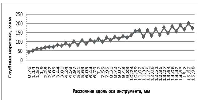
Рис. 15 Глубина нарезки инструмента ProFile 30.04 постепенно нарастает по всей длине режущей части инструмента от верхушки к хвостовику
