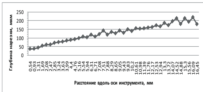
Рис. 20. Глубина нарезки инструмента ProFile 20 .06 быстро нарастает по всей длине режущей части инструмента от вершины к хвостовику
