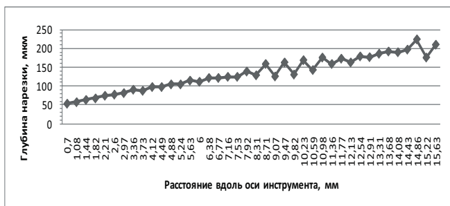
Рис. 30. Глубина нарезки инструмента ProFile 30.06 довольно быстро нарастает по всей длине режущей части инструмента от верхушки к хвостовику
