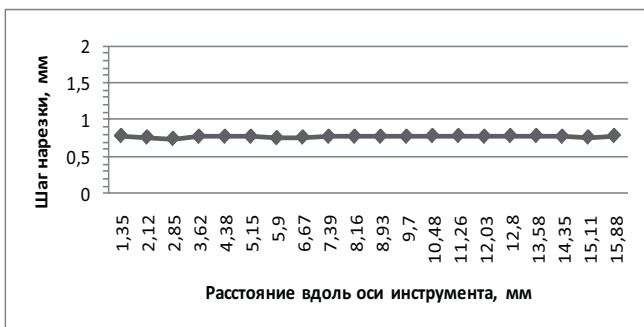
Рис. 23. Значение шага нарезки инструмента ProFile 25 .06 остается неизменным по всей длине режущей части от верхушки к хвостовику
