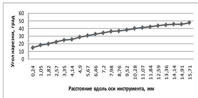
Рис. 9. Угол нарезки инструмента ProFile 25 .04 относительно резко увеличивается в направлении от верхушки к хвостовику
