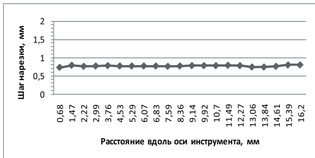
Рис. 18. Значение шага нарезки инструмента ProFile 20 .06 остается неизменным по всей длине режущей части от вершины к хвостовику
