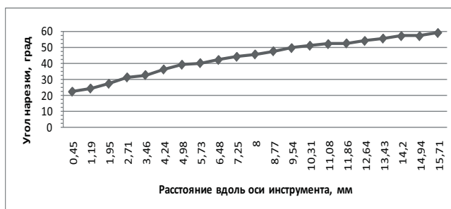
Рис. 29. Значения угла нарезки инструмента ProFile 30.06 достаточно резко увеличиваются примерно до середины режущей части инструмента, последующее увеличение угла нарезки происходит менее резко
