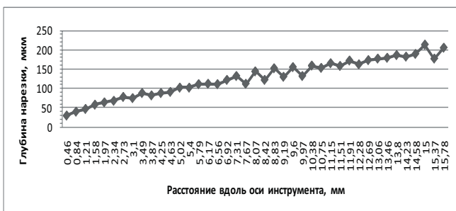
Рис. 25. Глубина нарезки инструмента ProFile 25 .06 нарастает по всей длине режущей части инструмента от верхушки к хвостовику
