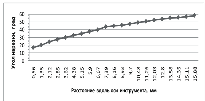
Рис. 24. Значения угла нарезки инструмента ProFile 25 .06 быстро увеличиваются примерно до середины режущей части инструмента, последующее увеличение угла нарезки происходит несколько менее резко
