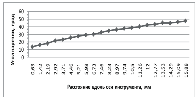
Рис. 4. Угол нарезки инструмента ProFile 20.04 довольно резко линейно увеличивается в направлении от верхушки к хвостовику
