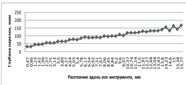
Рис. 5. Глубина нарезки инструмента ProFile 20.04 относительно равномерно возрастает по всей длине режущей части инструмента от верхушки к хвостовику
