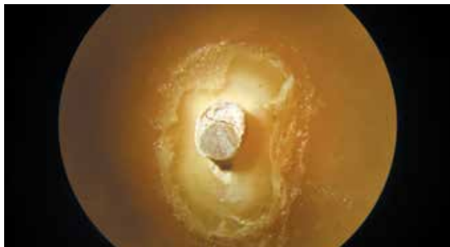
Рис. 1. Проведение испытания по определению прочности фиксации материала в канале корня зуба, образец находится на диске, пуансоном производится проталкивание штифта
