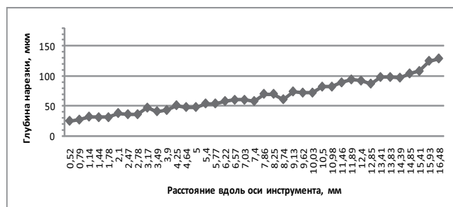
Рис. 10. Глубина нарезки инструмента FlexMaster 25 .04 равномерно нарастает по всей длине режущей части инструмента от верхушки к хвостовику
