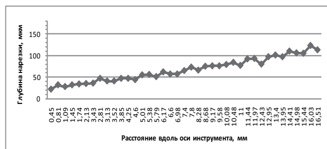
Рис. 15. Глубина нарезки инструмента FlexMaster 30.04 постепенно возрастает по всей длине режущей части инструмента от вершины к хвостовику
