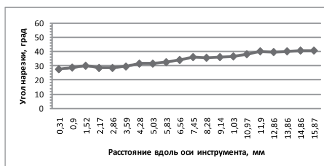
Рис. 14. Угол нарезки инструмента FlexMaster 30.04 в целом достаточно равномерно увеличивается от вершины к хвостовику
