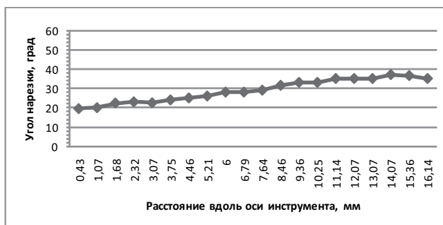
Рис. 4. Угол нарезки инструмента FlexMaster 20 .04 также в целом равномерно увеличивается в направлении от вертушки к хвостовику
