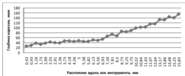
Рис. 20. Глубина нарезки инструмента FlexMaster 20 .06 медленно увеличивается примерно до середины режущей части инструмента, последующее увеличение глубины нарезки происходит значительно более резко
