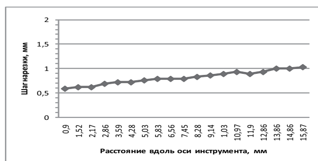
Рис. 13. Шаг нарезки инструмента FlexMaster 30.04 увеличивается в направлении от вершины к хвостовику
