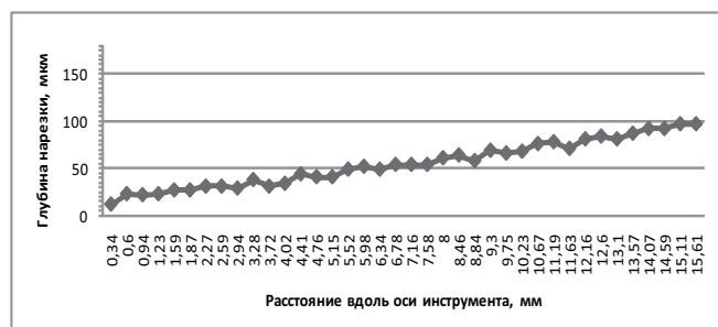
Рис. 5. Глубина нарезки инструмента FlexMaster 20 .04 равномерно возрастает по всей длине режущей части инструмента от вертушки к хвостовику
