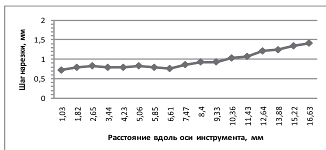
Рис. 18. Шаг нарезки инструмента FlexMaster 20 .06 остается практически постоянным примерно до середины режущей части инструмента. Затем происходит довольно резкое увеличение шага нарезки
