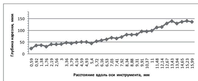
Рис. 25. Глубина нарезки инструмента FlexMaster 25 .06 медленно увеличивается примерно до середины режущей части инструмента, последующее увеличение глубины нарезки происходит несколько более резко
