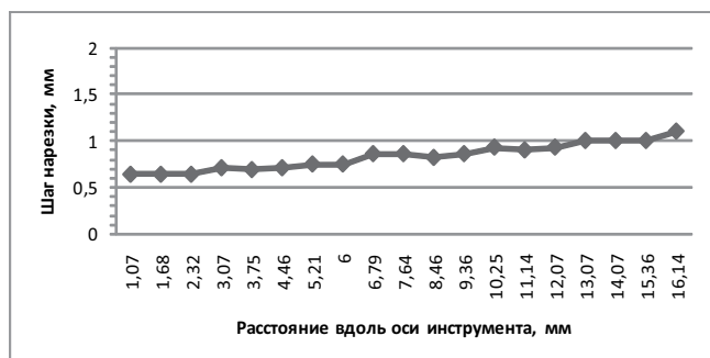
Рис. 3. Шаг нарезки инструмента FlexMaster 20 .04 увеличивается в направлении от вертушки к хвостовику
