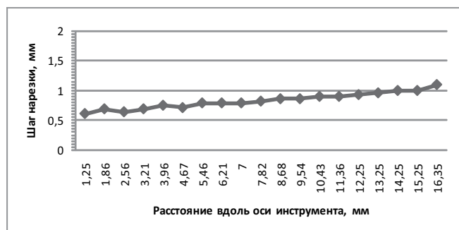
Рис. 8. Шаг нарезки инструмента FlexMaster 25 .04 увеличивается в направлении от верхушки к хвостовику
