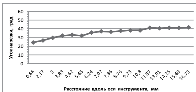
Рис. 29. Значения угла нарезки инструмента FlexMaster 30.06 быстро увеличиваются примерно до середины режущей части. Последующее увеличение угла нарезки происходит менее резко
