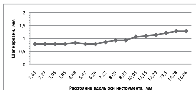
Рис. 23. Шаг нарезки инструмента FlexMaster 25 .06 практически неизменен на расстоянии от верхушки до середины режущей части инструмента. В последующем значения шага нарезки резко возрастают
