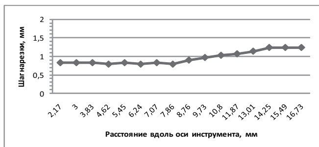
Рис. 28. Шаг нарезки инструмента FlexMaster 30.06 практически неизменен на расстоянии от вершины до середины режущей части инструмента. В последующем значение шага нарезки резко нарастает
