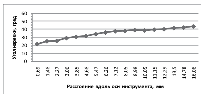
Рис. 24. Угол нарезки инструмента FlexMaster 25 .06 быстро увеличивается примерно до середины режущей части. Последующее увеличение угла нарезки происходит значительно менее резко
