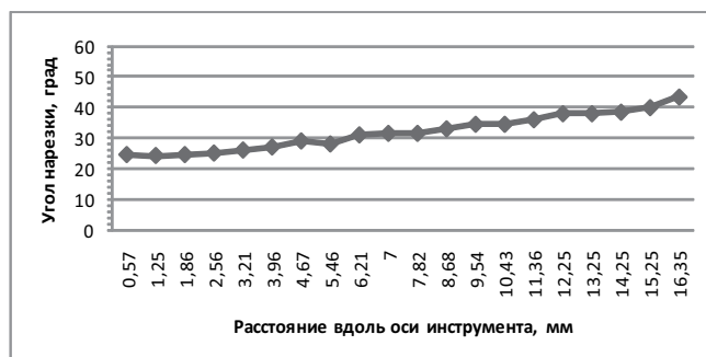
Рис. 9. Угол нарезки инструмента FlexMaster 25 .04 также в целом равномерно увеличивается от верхушки к хвостовику
