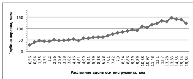
Рис. 30. Глубина нарезки инструмента FlexMaster 30.06 медленно увеличивается примерно до середины режущей части инструмента, последующее увеличение глубины нарезки происходит несколько более резко
