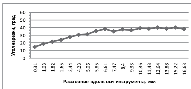
Рис. 19. Угол нарезки инструмента FlexMaster 20 .06 быстро увеличивается примерно до середины режущей части. Затем наблюдается медленное незначительное увеличение угла нарезки
