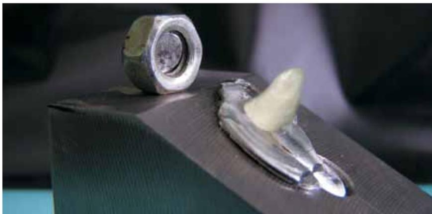
Рис. 5. Подложка с фиксированным образцом
