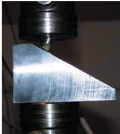
Рис. 3. Экспериментальная установка с нагрузочным механизмом
