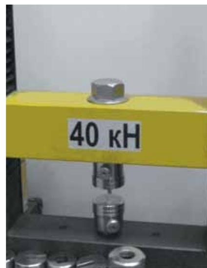
Рис. 1. Разрывная машина МИ-40-КУ
