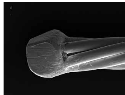
Рис. 5. Микрофотография экспериментальной режущей головки и прилегающей рабочей части образца, изготовленного из стального троса конфигурации (147)
