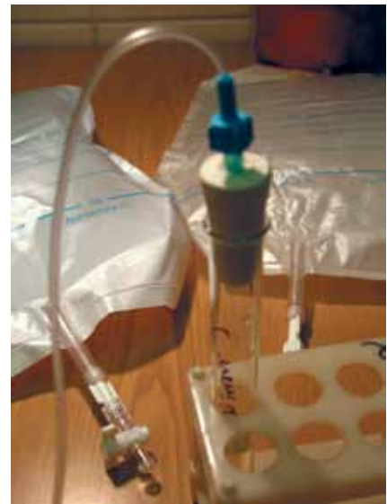
Рис. 5. Подача озono-кислородной смеси через катетер-иглу во взвесь микроорганизмов
