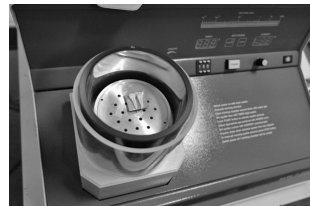
Рис. 3-4. Нанесение напыления на образцы в вакуумной установке Bal-tec SCD 005
