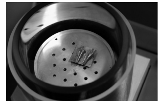
Рис. 3-4. Нанесение напыления на образцы в вакуумной установке Bal-tec SCD 005
