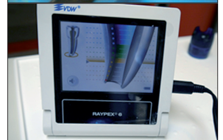
Рис. 10а,б. Измерение рабочей длины корневых каналов апекс-локатором Rarex 6
