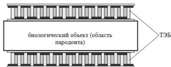
Рис. 2. Физическая модель ТЭС для лечения воспалительных заболеваний пародонта методом умеренного криовоздействия
